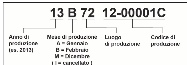
Figura 5-1: targhetta con dati di produzione
